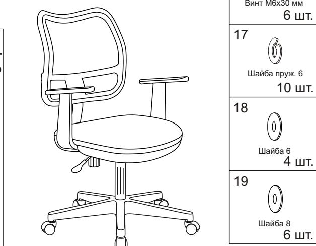
**Примечание:** Шаг 1. Снять защитный колпачок с газлифта, в случае его наличия.
